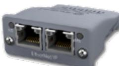
Durch den Einsatz einer Feldbusverbindung kann die Verkabelung deutlich vereinfacht werden. Die Kommunikation zeichnet sich durch absolute Zuverlässigkeit und extrem hohe Leistung in der Übertragungsrate und -menge im Datenaustausch zwischen Maschine und MARPOSS-Überwachungssystem aus. Durch seine geringen Abmessungen und den einfachen Anschluss lässt sich die FELDBUS-Schnittstelle direkt auf dem Zentralmodul unterbringen.
